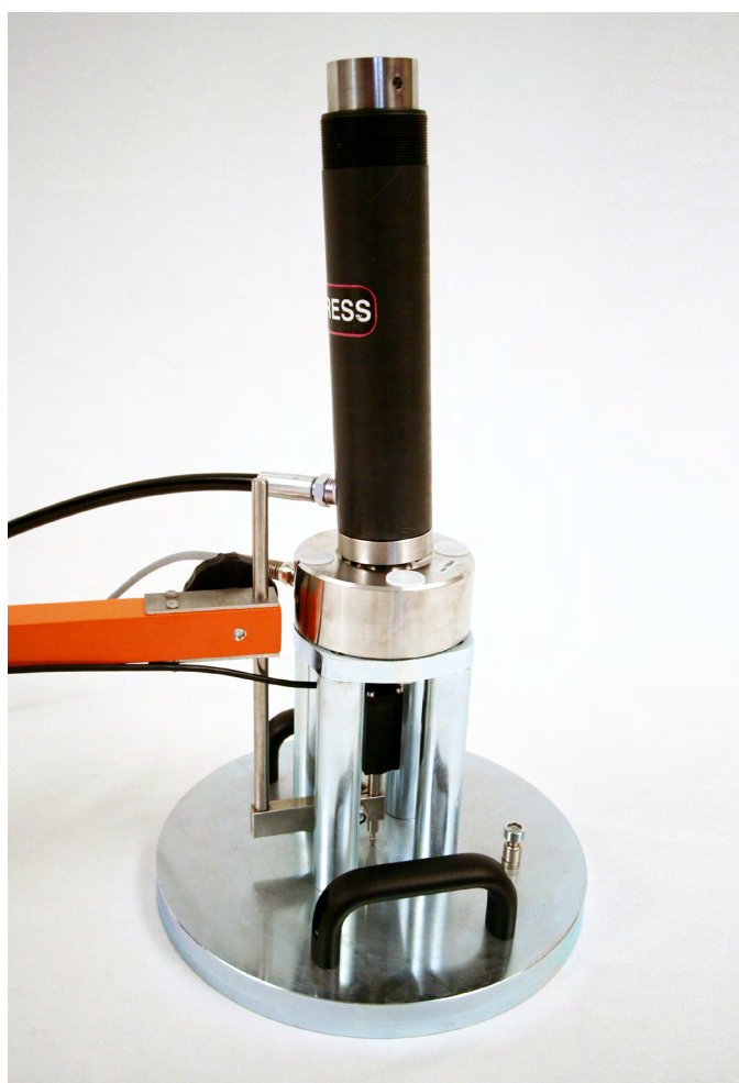
Figura 3 - Piastra di carico in acciaio S355JO con trattamento di superfici inossidabile, diametro 300 mm
