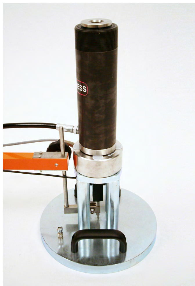
Figura 4 - Cilindro a pressione con una forza di pressione di 100 kN
