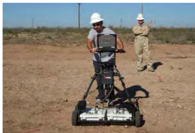
RIS MF Hi-Mod: rilievo su terreni accidentati
