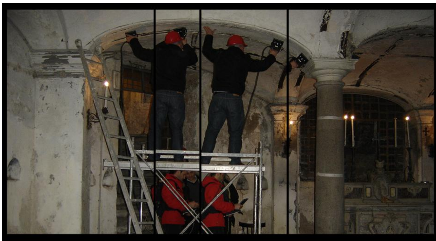
Fig. 5: Applicazione georadar con antenna ad alta frequenza per indagini su strutture nell'ambito delle indagini preliminari per la cripta di S. Candida, basilica di S. Pietro ad Aram (NA)
