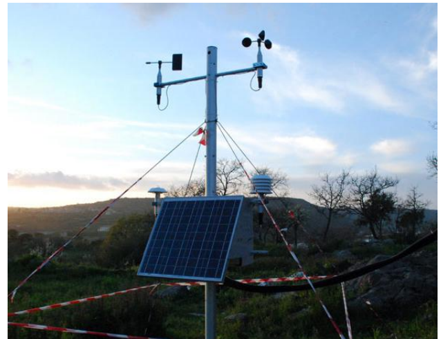
Stazione meteo con: tacoanemometro (in alto a DX); pannello solare; gonioanemometro (in alto a SX); sensore di temperatura e umidità esterna (alla DX del pannello);
