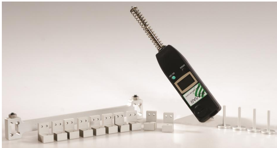
Fessurimetro con dima, scopi e basette in alluminio anodizzato
