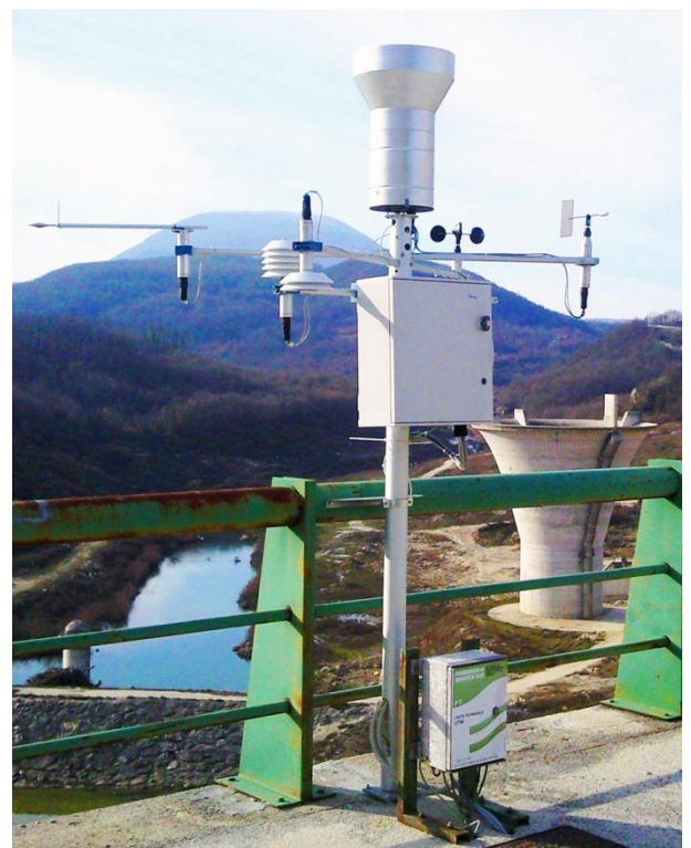
Stazione meteo con: anemometro (sensore a DX); gonioanemometro (DX); sensore di temperatura e umidità esterna (SX); sensore radiazione solare (SX); nivometro (al centro); pluviometro (sopra).
